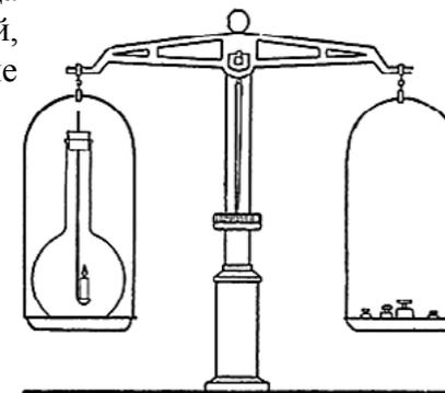
Рис. 8. Прибор для демонстрации закона сохранения массы веществ
